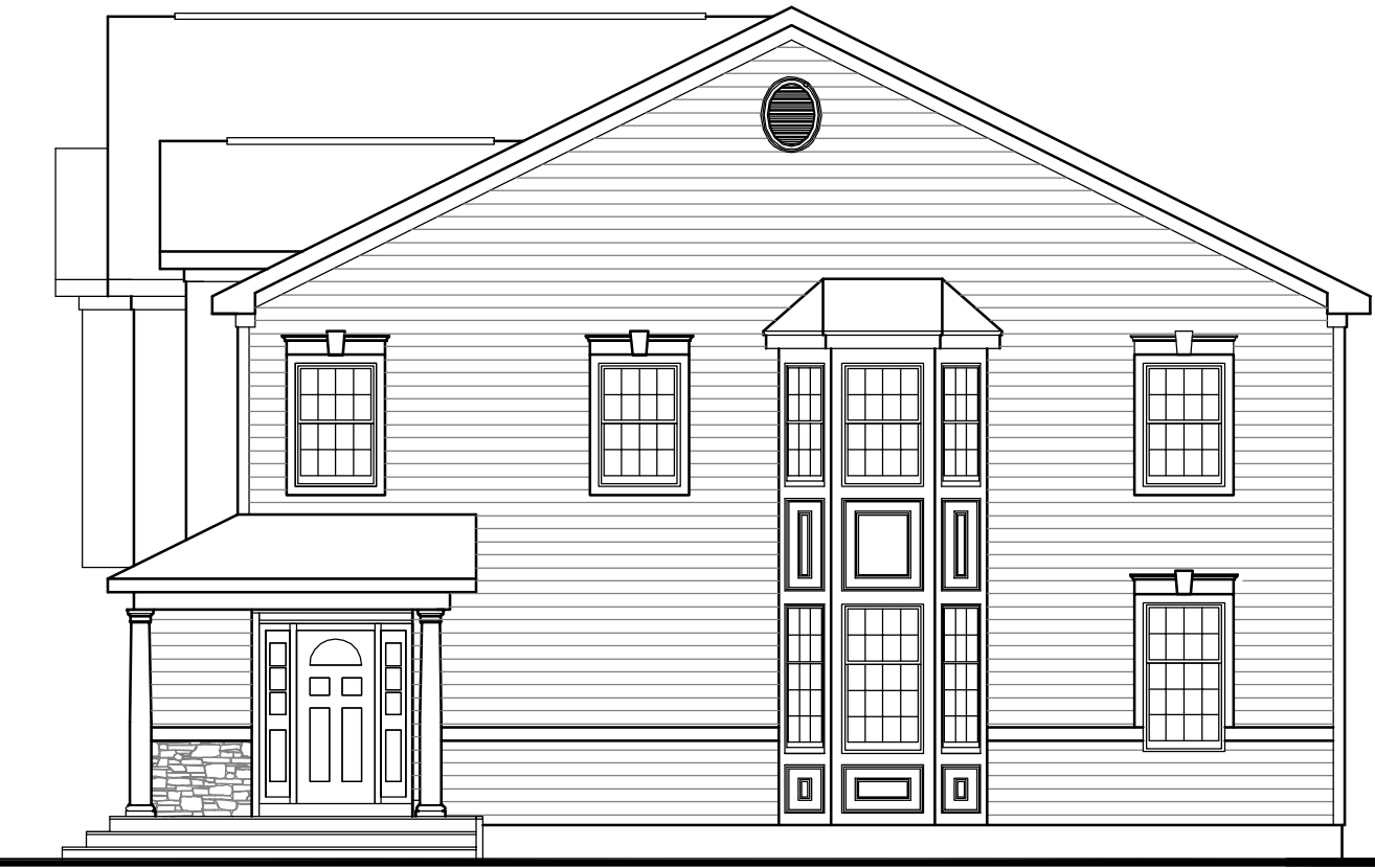
RIGHT SIDE ELEVATION SCALE: 1/8" = 1'-0"
